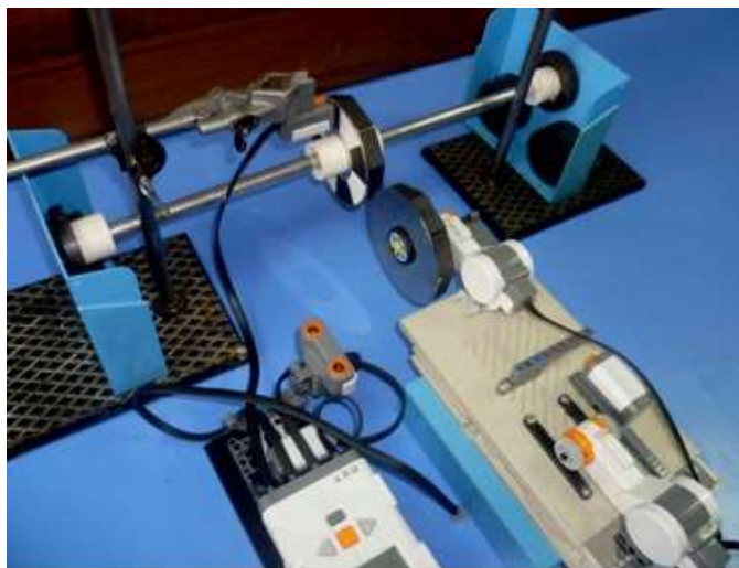
Рис. 3. Модель роботизированной установки для изучения магнитной передачи «Магнитная муфта»
