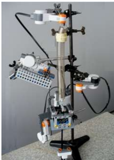
Рис.1. Установка для исследования закономерностей колебаний пружинного маятника
